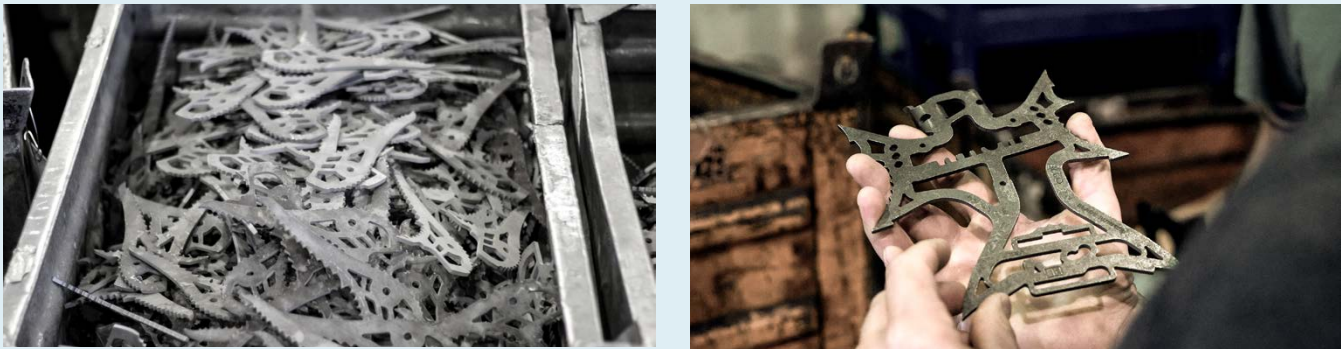
Eishauen und Steigeisen werden aus Stahlplatten gelasert. Fotos: Camp
