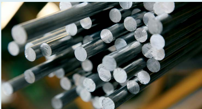
Gepresste runde Stangen aus Aluminium.
