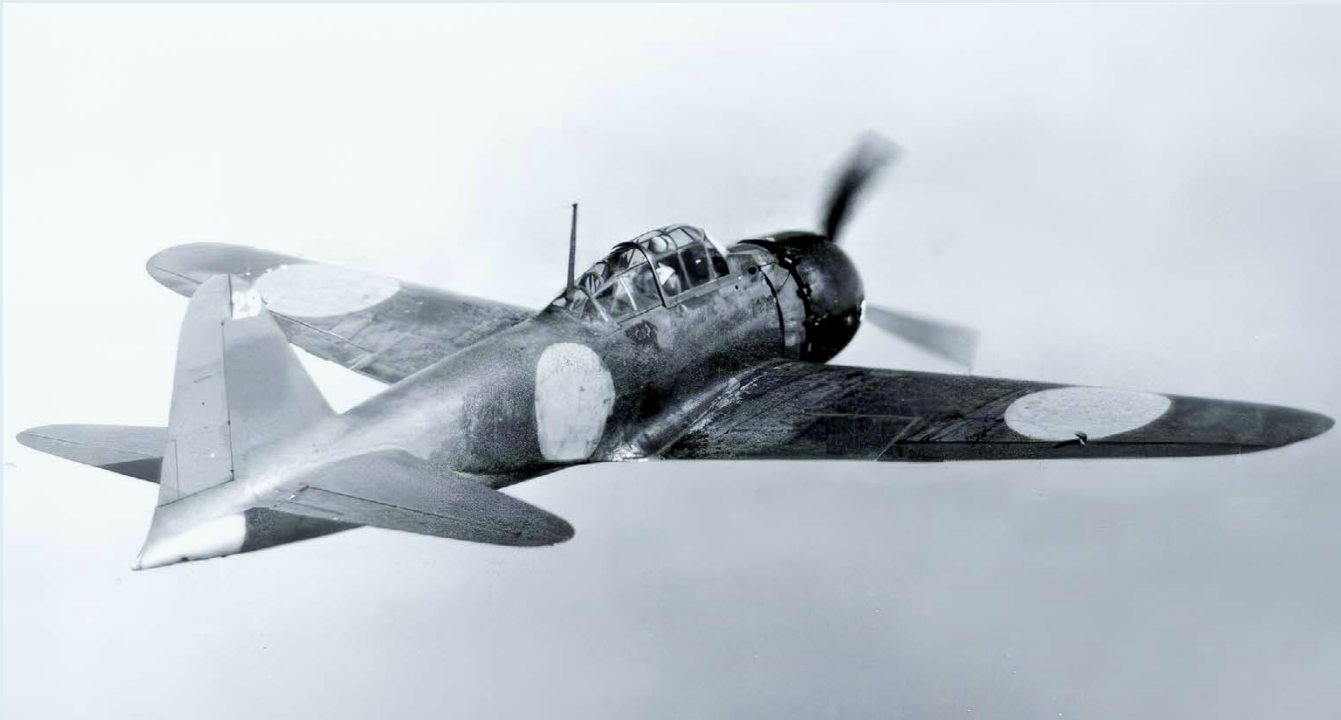
Mitsubishi A6M Zero, der erste Flieger aus Extra Super Duralumin. Foto: Naval History and Heritage Command
