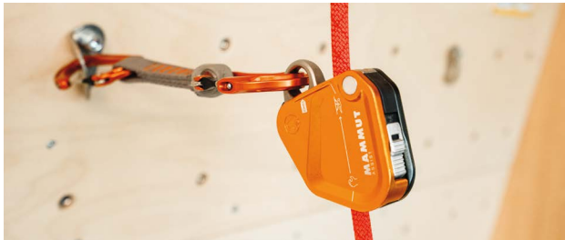
Abb. 5 Bei Verwendung einer Expresssling (max. 30 cm Länge) ist die Kompensation beim Assist aufgrund des Umschlagwegs und der damit einhergehenden späteren Aktivierung geringer als mit einfachem Karabiner (Boost-Mode).
