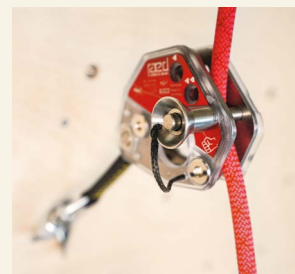
Abb. 1 und 2 Geräte mit Umschlingungswinkel: Bauer Espresso (li.) und Zaed .
