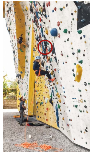
Abb. 10 Eine der Sturzreihen in der Kletterhalle: Gewichtsunterschied 29 kg, passives Sicherungsverhalten, Seildurchmesser 9 mm. Die unterschiedlich starke Bremswirkung der Geräte wird durch die Höhe der sichernden Person verdeutlicht. v.l.n.r.: nur mit Karabiner, Zaed Stufe 2, Ohm.
