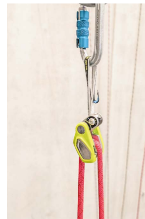
Abb. 9 Beim Sturz ins Gerät fungiert das Zaed lediglich wie eine Exe ohne Kompensationswirkung, das Espresso weist reibungserhöhende Einkerbungen auf der Bremsscheibe auf. Auch das Assist hat einen extra Schlitz dafür. Das Ohmega, funktioniert genauso wie beim Sturz in eine Zwischensicherung.
