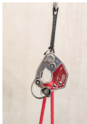
Abb. 9 Beim Sturz ins Gerät fungiert das Zaed lediglich wie eine Exe ohne Kompensationswirkung, das Espresso weist reibungserhöhende Einkerbungen auf der Bremsscheibe auf. Auch das Assist hat einen extra Schlitz dafür. Das Ohmega, funktioniert genauso wie beim Sturz in eine Zwischensicherung.
