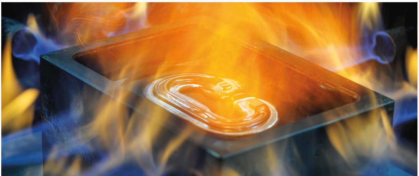
Heißgeschmiedet wird bei knapp 200 Grad Celsius in Pressen, die über tausend Tonnen Kraft ausüben können. Foto. DMMR, Ray Wood
