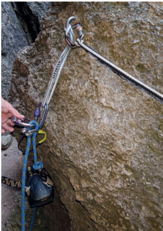
Abb. 2 Das Gerät hat sich am Felsen verhakt und die Bremswirkung wurde komplett aufgehoben.
